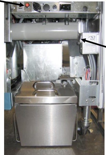
الشكل ٧: وضع تركيب وحدة الإذابة بشكل صحيح.
