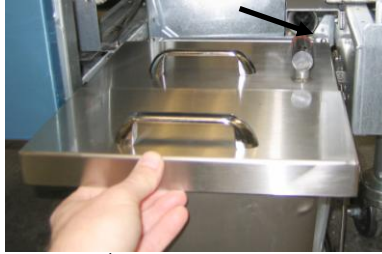
الشكل ٤: ضع الغطاء على الوعاء وأدخل أنبوب سحب الزيت في مقبس السحب الأنثى.
