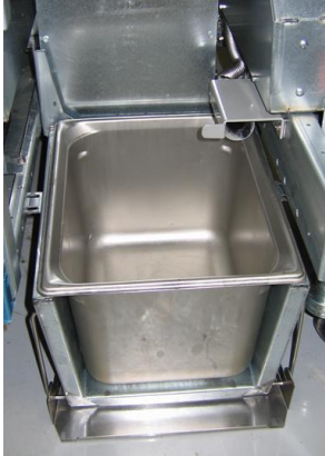
الشكل ٣: ثبت وعاء خزان الزيت الداخلي في وحدة الإذابة.
